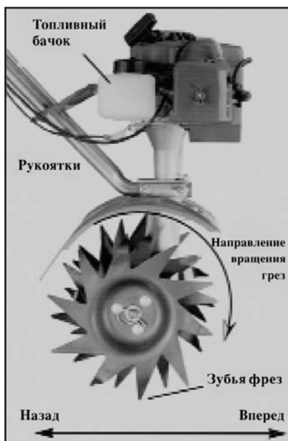
Положение вспашки: Зубья фрез смотрят в сторону вращения фрез, т.е. вперед.
